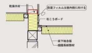
床に段差がある場合は、断熱材が連続するように立上り部分にも施工します。
